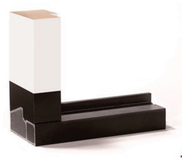
Afb. 5.28 Deze BUVA-ISOSTONE® onderdorpel van glasvezel versterkt kunststof is gevuld met PUR-schuim en heeft daardoor een gunstige U_{\text{frame}} -waarde van circa 0,9 à 1,0 W/(m 2 ·K) afhankelijk van het type dorpel; de versies voor hefschuifdeuren hebben een U_{\text{frame}} -waarde van 1,6 à 1,9 W/(m 2 ·K). (Bron: BUVA BV)
